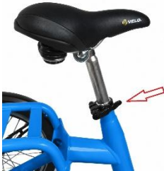
Zadelhoogte via snelspanner met behulp van hendel
